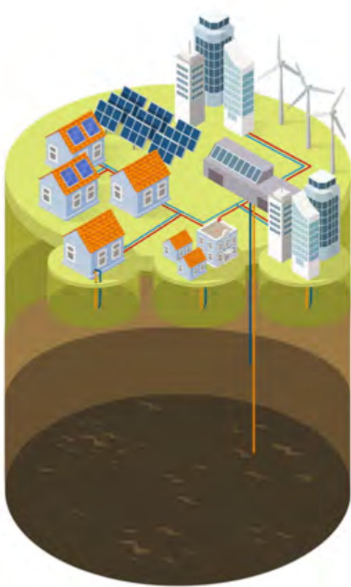
Mijnwater uit oude mijngangen. (Afbeelding: Mijnwater B.V.)
